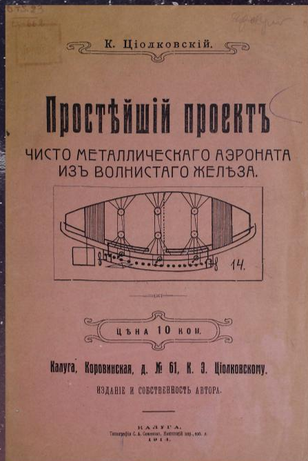
14. Схема металлического дирижабля. Верхнее основание. Блочное стягивание. Черные трубы для нагревания газа. Нижнее основание с прилегающими к нему камерами с клапанами для накачивания тросов блочной системы. Гондолы. Рули. Моторы с гребными винтами. Ряд окон.
